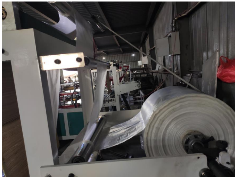
Рис. 4 Направление пленки в устройство
