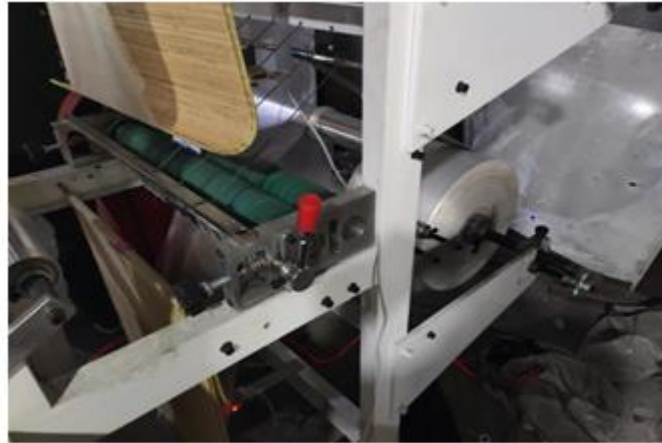
Рис. 5 Ручка регулировки расстояния между валиками
